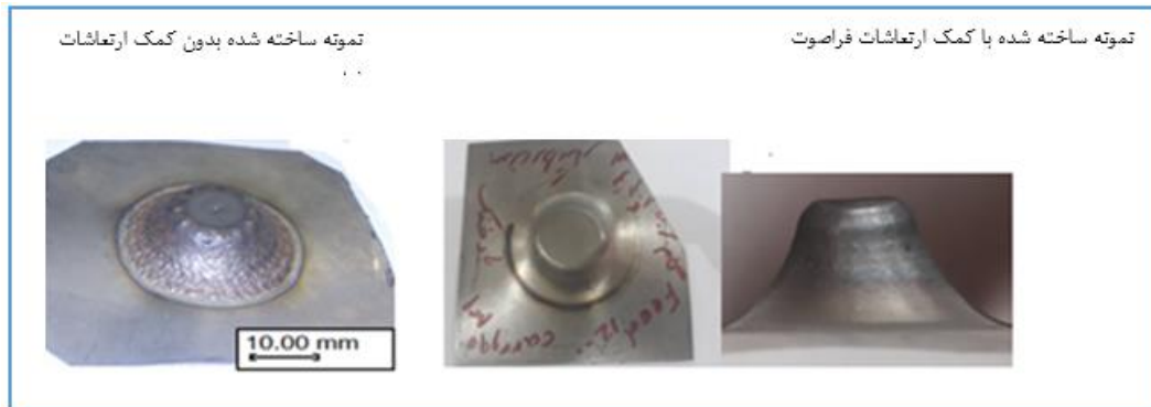
شکل ۱۰) مقایسه اختلاف ظاهری قطعات ساخته شده به کمک ارتعاشات فراصوت و تنظیم پارامترهای بهینه (تنظیم گام عمودی ۰/۱mm، سرعت پیشروی حدود ۹۰۰ mm/min و میزان شدت جریان ۲۲۰A) با قطعه ساخته شده بدون کمک ارتعاشات فراصوت و تنظیم همان پارامترها
