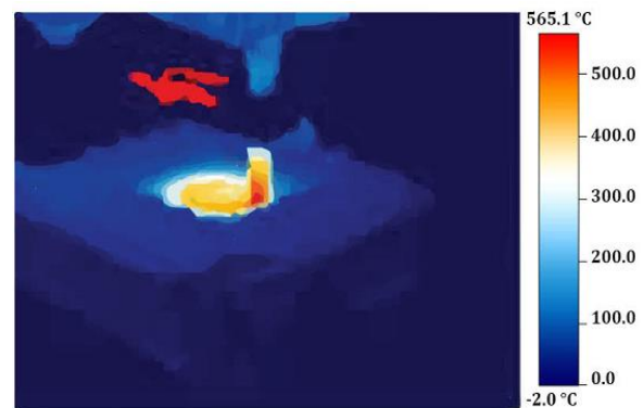
شکل ۵) ترموگرافی هم‌افزایی اثر ارتعاشات فراصوت و گرمای ژول
