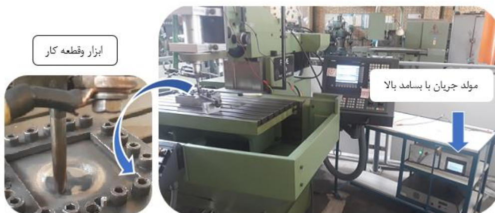
شکل ۲) مجموعه تجهیزات شکل‌دهی تدریجی گرم با کمک امواج فراصوت به همراه دستگاه فرز CNC مورد استفاده در این پژوهش
