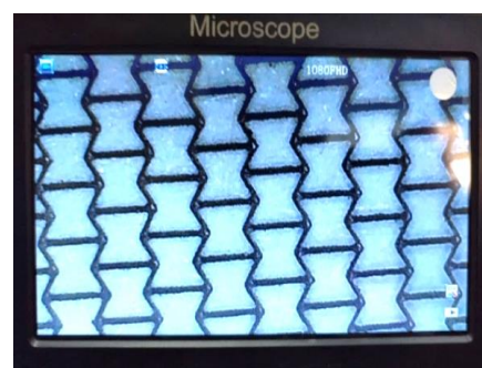
شکل ۴) سلول‌های سازه آگرتیک میکروسلولی زیر میکروسکوپ
