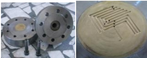
شکل ۵ مجموعه قالب ساخته شده برای شکل‌دهی شیارهای تکرارشونده
