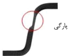
شکل ۲۲ موضع پارگی در نسبت w/s = 1/92 با شکل‌دهی در فشار ۱۵۰ مگاپاسکال
