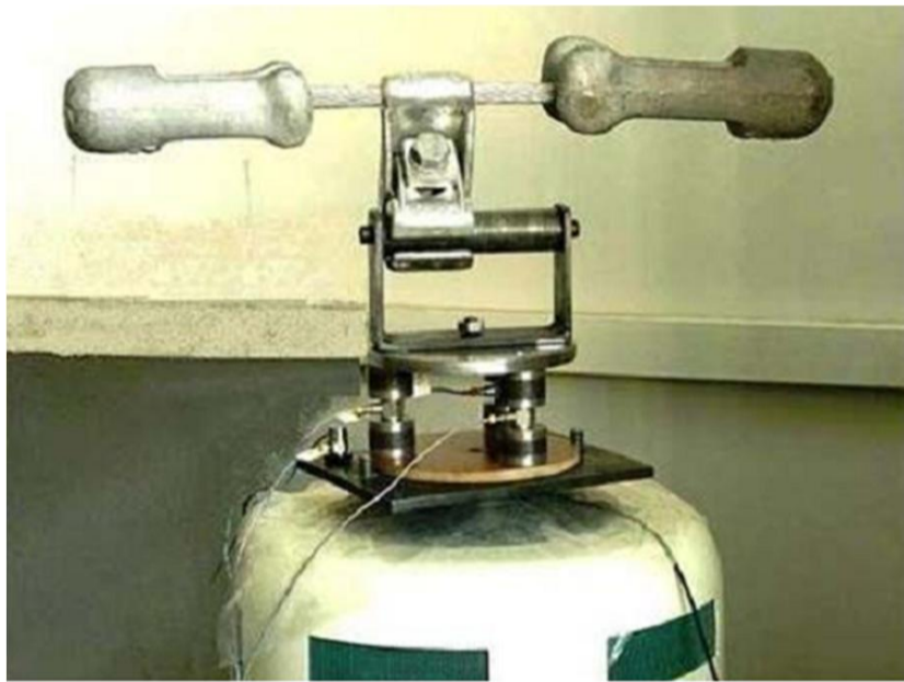
شکل 3 نمایش اتصال میراگر استاک بریج به لرزاننده به همراه حسگرهای نیرو
