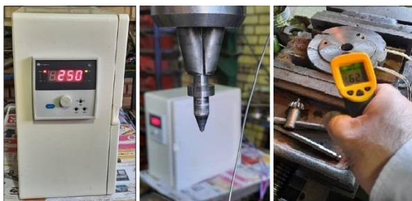
شکل (۴) نحوی کنترل دمای مورد نیاز در حین فرایند
