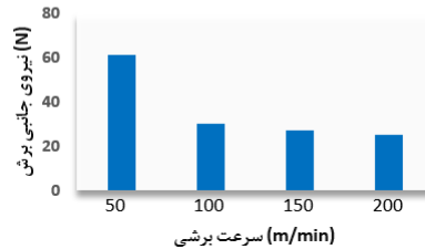
شکل ۸: تاثیر سرعت برشی بر نیروهای ماشینکاری
