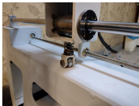
شکل ۳) فنر استفاده شده در سیستم متعادل‌کننده
