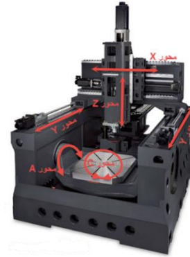
شکل ۱۵) نمای کلی ماشین ۵ محور مورد آزمایش
