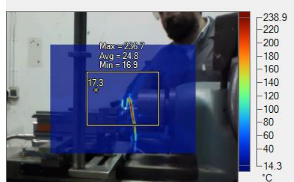
شکل ۴ تحلیل دما با استفاده از نرم‌افزار SmartView در سرعت ۸۰۰ (دور بر دقیقه) ، نرخ پیشروی ۰/۱۰۵ میلی‌متر بر دور و عمق برش ۰/۱۶ میلی‌متر
