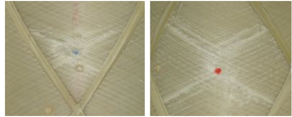
شکل ۷ گسترش سطح شکست
