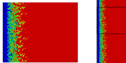
شکل 4 جریان فیلم میعان بر روی سطح قائم ب: نتایج مدل‌سازی (توزیع حجم کسری) ج: بزرگنمایی نتایج قسمت ب
