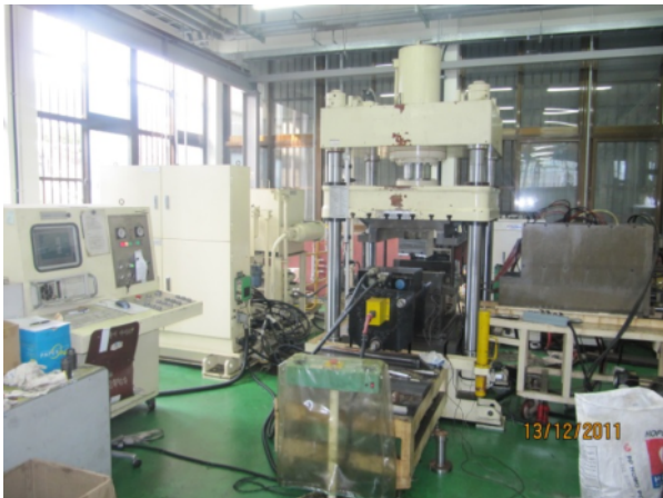
شکل ۷ دستگاه هیدروفرمینگ گرم لوله (آزمایشگاه فناوری‌های پیشرفته تولید، دانشگاه ملی پوسان، کره جنوبی)
