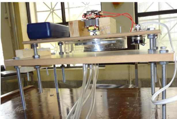
شکل 3 دستگاه ساخته شده جهت آزمایش جاذب گردابه‌ای
