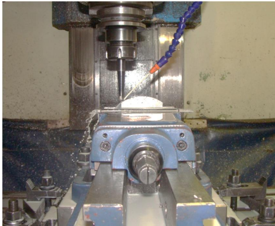
شکل 4 چیدمان انجام آزمایش به همراه قطعه کار در فرزکاری
