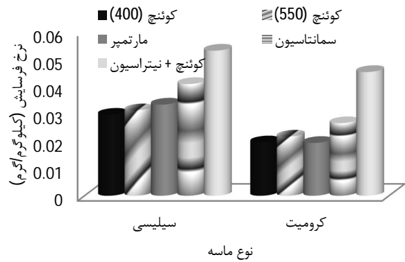
شکل 8 نرخ سایش فرسایشی فولاد AISI H13 با انواع ماسه ماهیچه در فشار پاشش 3 بار
