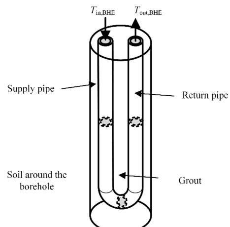
شکل 5 طرح نمادینی از یک مبدل حرارتی گمانه
