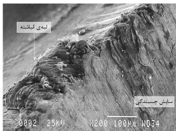
شکل ۱۱ لبه‌ی انباشته در ابزار برشی در سرعت برشی ۷۰ m/min و پیشروی ۰/۱۵ mm/min
