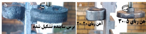
شکل ۳ (a) مکانیزم به کار رفته (b) برس ساینده تشکیل شده در حین انجام آزمایش
