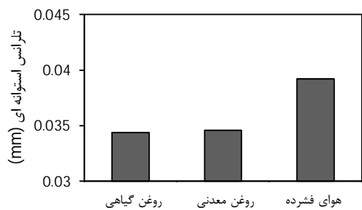
شکل 20 اثر سیال برشی بر تلرانس‌های استوانه‌ای سوراخ
