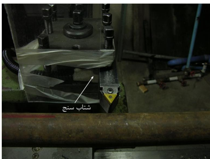
شکل 1 تنظیمات و محل قرارگیری شتاب‌سنج در آزمایش‌ها
