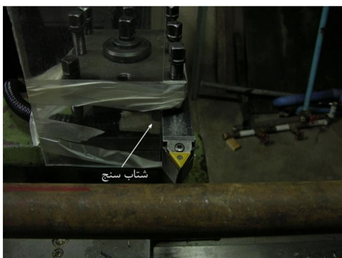
شکل 1 تنظیمات و محل قرارگیری شتاب‌سنج در آزمایش‌ها
