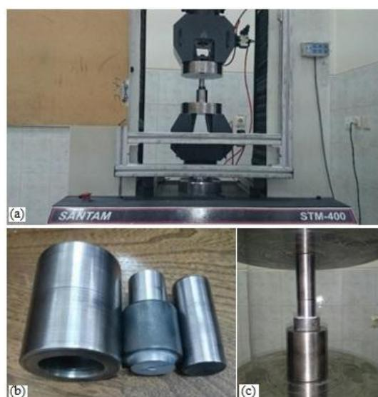
شکل ۴ فرآیند استخراج با فیکسچر و ماشین تست یونیورسال. (الف) ماشین تست یونیورسال. (ب) فیکسچر طراحی شده برای استخراج اتصالات سرهم شده. (پ) قطعات سرهم شده و فیکسچر طراحی شده بر روی ماشین تست یونیورسال
