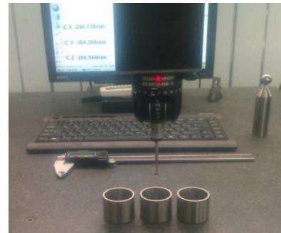
Fig. 2 اندازه گیری ابعاد بوش توسط ماشین اندازه گیری مختصات (CMM)
