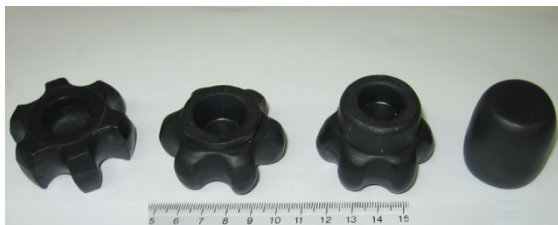
شکل ۲۸ نحوه شکل گیری قطعه گردویی در کورس‌های مختلف جابه‌جایی سنبه
