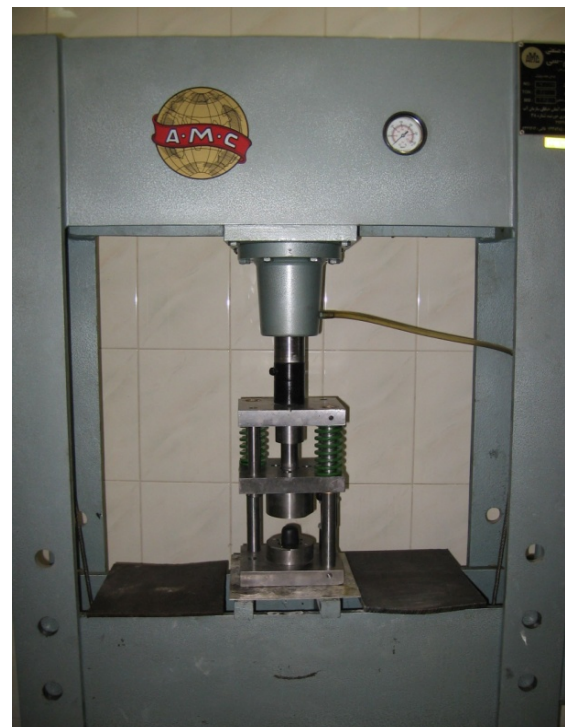
شکل ۲۶ بیلت اولیه داخل قالب قبل از تغییر شکل زیر پرس هیدرولیک
