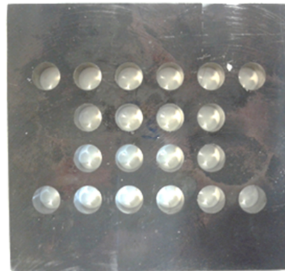
شکل ۱ نمایی از سوراخ‌های تولیدی با استفاده از فرآیند برق‌زنی
