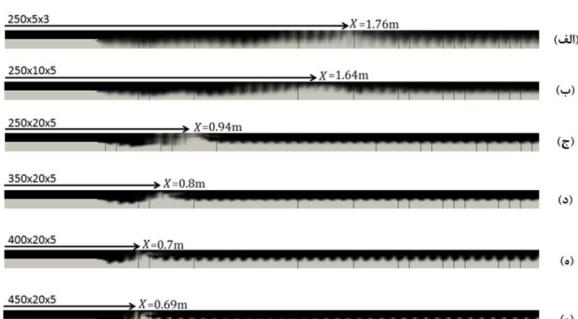
شکل 9-2 محل تشکیل اسلاگ در شبکه‌بندی‌های مختلف کanal ریبدار
