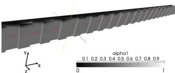
شکل 15 شبیه‌سازی سه بعدی جریان پلاگ در کانال ریبدار با مشخصات  $e=4\text{mm}$ ,  $u_0=0/3\text{m/s}$ ,  $P=80\text{mm}$ ,  $w=40\text{mm}$
