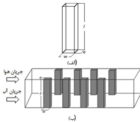
شکل 7 ابعاد ریب‌های مورد استفاده (الف) و طرز قرارگیری آن‌ها در دیوارهای جانبی کanal (ب)
