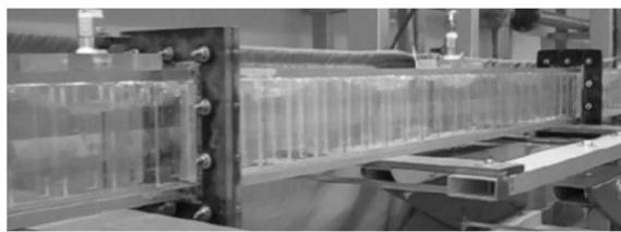
شکل 11 رژیم پلاگ برای  $U_g = 4 \text{ m/s}$ ,  $U_i = 0.8 \text{ m/s}$
