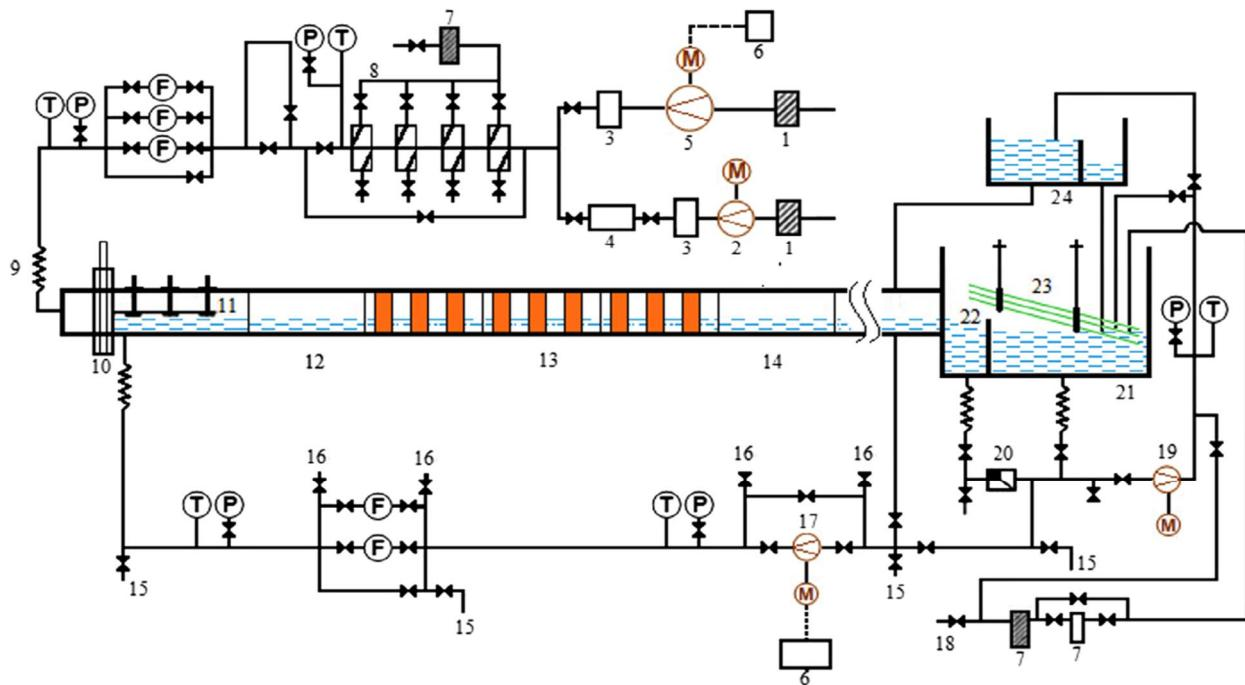
1: فیلتر هوای 2: کمپرسور 3: مخزن هوای 4: رگلاتور فشار 5: دمنده 6: سیستم کنترل 7: فیلتر آب 8: سیستم خنک کاری هوای 9: لوله قابل انعطاف 10: دریچه لغزشی 11: صفحه فلزی 12: ورودی کanal 13: مقطع ریبدار 14: خروجی کanal 15: پمپ 16: تخلیه 17: پمپ 18: تأمین آب 19: پمپ 20: شیر یک طرفه 21: مخزن 22: صفحه کنترل سطح 23: اسلاگ دمپر 24: مخزن 1 F: فلومتر M: موتور الکتریکی P: فشارسنج 7: دماسنجد
