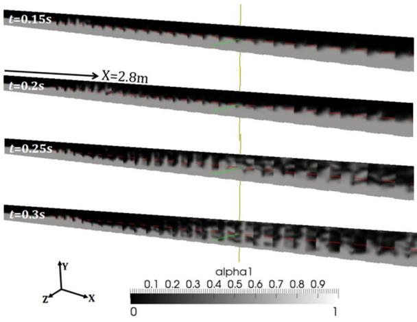
شکل 17 شبیه‌سازی سه بعدی جریان اسلاگ در کانال ریبدار در زمان‌های متواتی با مشخصات  $u_0=16\text{m/s}$ ,  $u=1\text{m/s}$ ,  $P=80\text{mm}$ ,  $w=40\text{mm}$ ,  $e=4\text{mm}$
