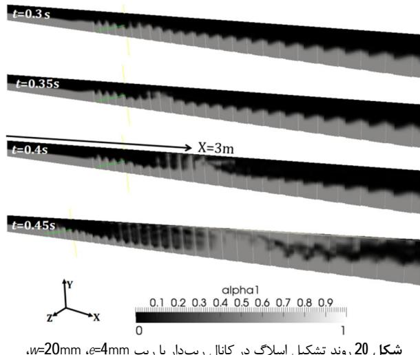
شکل 20 روند تشکیل اسلاگ در کanal ریبدار با ریب  $w=20\text{mm}$ ,  $e=4\text{mm}$ ,  $P=60\text{mm}$ ,  $U_f=16\text{m/s}$ ,  $U=1\text{m/s}$
