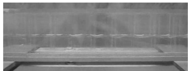
شکل 10 رژیم موجی برای  $U_g = 6 \text{ m/s}$ ,  $U_i = 0.16 \text{ m/s}$
