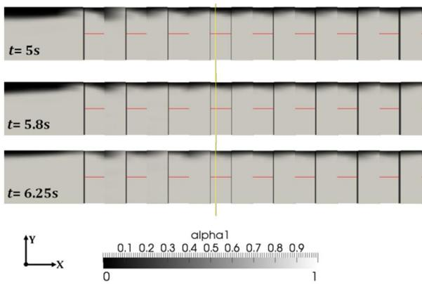
شکل 16 شبیه‌سازی سه بعدی جریان پلاگ در زمان‌های مختلف در کانال ریبدار ( $z=0$ ) با مشخصات ( $z=0$ ,  $x-y$ )  $u_0=2\text{m/s}$ ,  $u=0/11\text{m/s}$ ,  $P=80\text{mm}$ ,  $w=40\text{mm}$ ,  $e=4\text{mm}$
