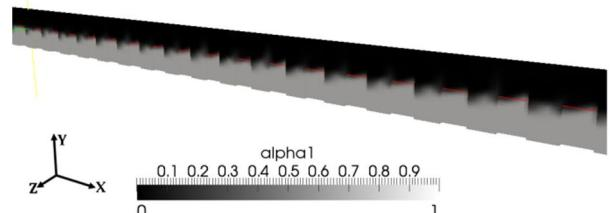
شکل 14 شبیه‌سازی سه بعدی جریان موجی در کانال ریبدار با مشخصات  $e=4\text{mm}$ ,  $u_0=4\text{m/s}$ ,  $u=0/18\text{m/s}$ ,  $P=80\text{mm}$ ,  $w=40\text{mm}$
