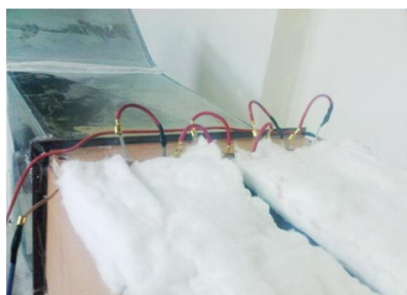
شکل 3 سطح شار ثابت با عایق پشم سنگ
