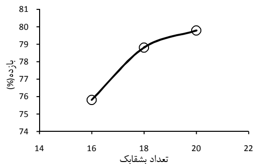
شکل ۲۲ تاثیر تعداد بشقابک با تغییر دادن قطر گام در اندازه بشقابک ثابت بر بازده
