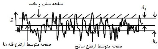
شکل 2 تماس سطح زبر معادل با یک سطح صاف و تخت
