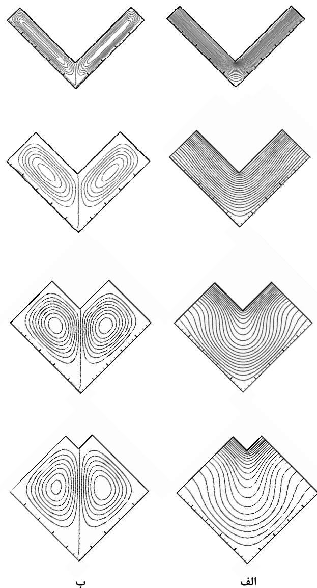
شکل ۹ خطوط همدمان (الف) و جریان (ب) در نسبت ابعاد مختلف محفظه ( $Ra=10^4$ ,  $\phi=0.03$ ,  $\theta=45^\circ$ )
