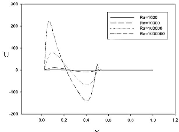
شکل ۵ پروفیل سرعت در جهت  $X = 0.5$  در  $\theta = 45^\circ$ ,  $\phi = 0.03$ ,  $A = W/L = 0.5$
