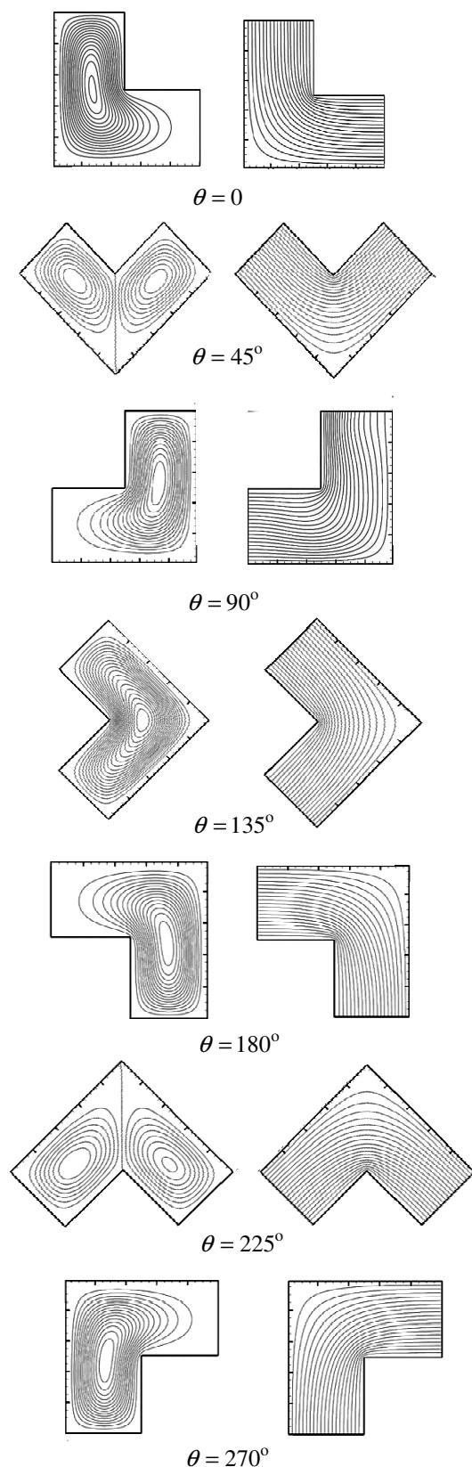
شکل ۸ خطوط جریان (چپ) و همدم (راست) در زاویه‌های مختلف
