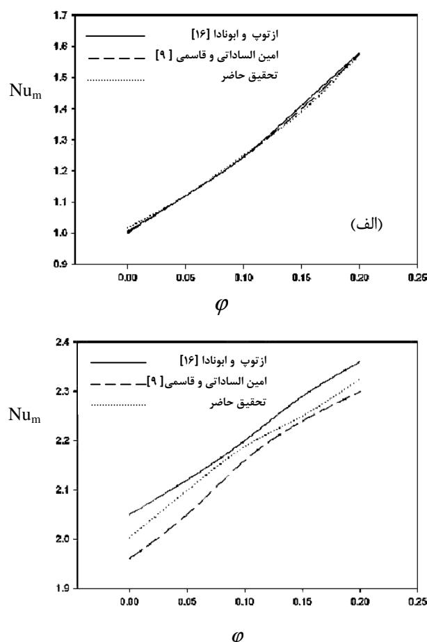
شکل ۳ مقایسه نوسلت متوسط محفظه مربعی حاوی نانوسیال با دیگر مراجع (الف) (ب) ( $\text{Ra} = 10^3$ ) ( $\text{Ra} = 10^4$ )
