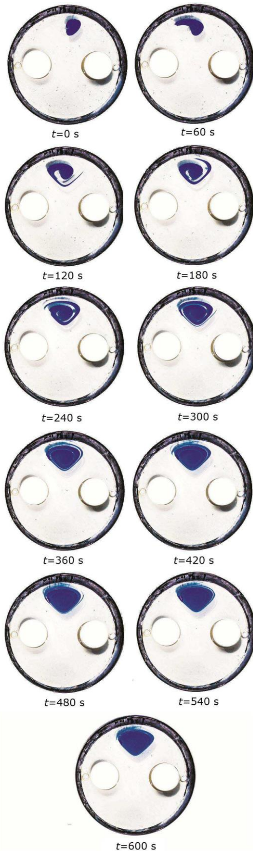
Fig 4 Dye mixing in the mixer with constant speed of rotors شکل 4 اختلاط رنگ در همزن با سرعت دورانی ثابت روتورها
