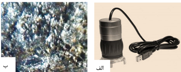
شکل ۵ میکروسکوپ مورد استفاده (الف) نمونه تصویر تهیه شده از سطح چرخ‌سنگ (ب)
