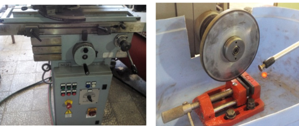
شکل ۴ نمایی از ماشین سنگ‌زنی و تجهیزات نصب شده
