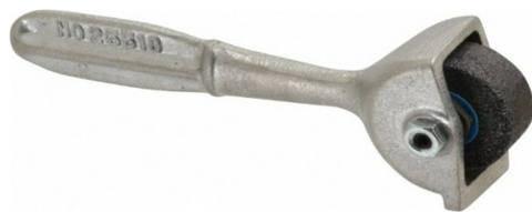
شکل ۶ درسر مورد استفاده جهت آماده‌سازی چرخ‌سنگ
