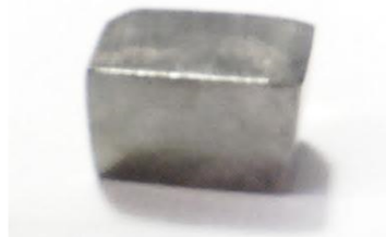
شکل ۷ قطعه‌کار اینکونل ۷۳۸ مورد استفاده
