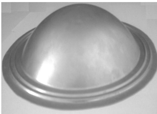
شکل ۴ ورق شکل گرفته در تست آزمایشگاهی
