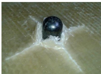
شکل ۱۱ تأثیر نفوذ کننده سرنیم‌کروی بر ورق کامپوزیتی
