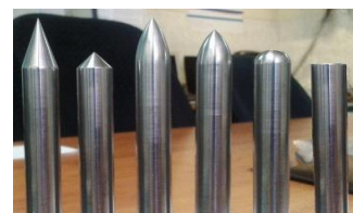
شکل 2 پارامترهای نفوذ کننده اجیوال برای تعیین شعاع کالیبر دماغه
