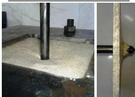
شکل 4 آزمایش نفوذ شبه استاتیکی
