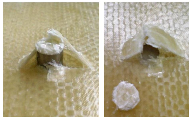
شکل ۹ تأثیر نفوذ کننده سرتخت بر ورق کامپوزیتی
