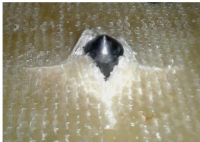
شکل ۱۰ تأثیر نفوذ کننده سرمخروطی 90^\circ بر ورق کامپوزیتی
