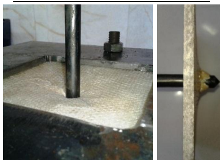
شکل 4 آزمایش نفوذ شبه استاتیکی
