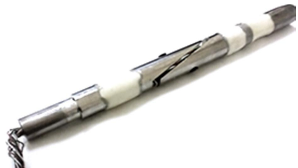
شکل 9 بالانس شش مؤلفه‌ای نیرو گشتاور ساخته شده
