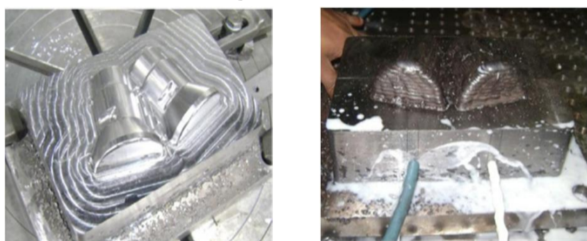
شکل 3 ساخت قالب به همراه سیستم خنک‌کاری [5]
