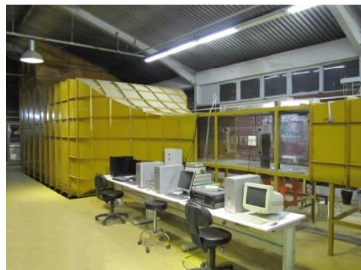
شکل 2 تونل باد مورد استفاده در تحقیق کنونی
