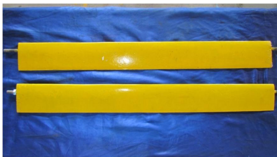
شکل 5 استروت‌ها با مقطع هیدروفویل شکل
