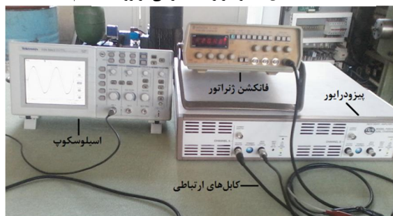
شکل 4 تجهیزات تست و تنظیم فرکانس
