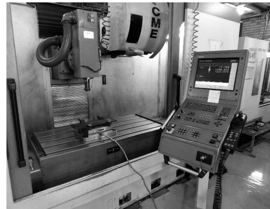
شکل ۳ نمایی از مواد و تجهیزات آزمایش فرزکاری ماریچ
