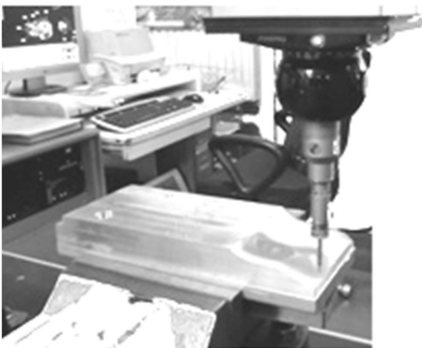
شکل 5 مرحله اندازه برداری نقاط توسط ماشین اندازه گیری مختصات
