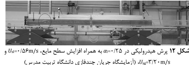
شکل ۱۲ پرش هیدرولیکی در  $\alpha=0/25$  به همراه افزایش سطح مایع،  $U_{sl}=0.56\text{m/s}$  و  $U_{sg}=3/20\text{ m/s}$  (آزمایشگاه جریان چندفازی دانشگاه تربیت مدرس)
