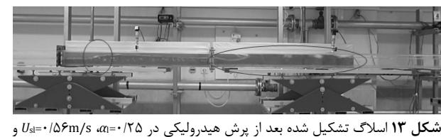
شکل ۱۳ اسلامگ تشکیل شده بعد از پرش هیدرولیکی در  $\alpha=0/25$  و  $U_{sl}=0.56\text{m/s}$ ،  $U_{sg}=3/20\text{ m/s}$  (آزمایشگاه جریان چندفازی دانشگاه تربیت مدرس)
