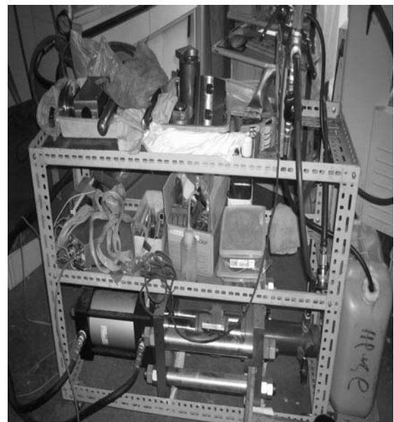
شکل ۴ دستگاه تولید کننده فشار هیدرولیکی نوسانی
