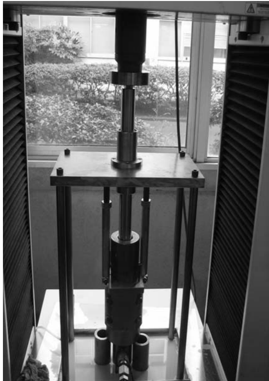
شکل ۵ تصویر مجموعه قالب استفاده شده در آزمایش
