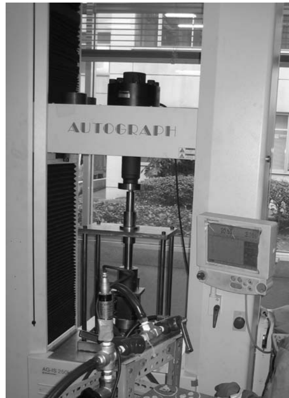
شکل ۳ دستگاه پرس اونیورسال استفاده شده در آزمایشها و مجموعه قالب نصب شده بر روی آن
