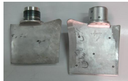
شکل ۱ پره فن ژنراتور زمینس، قطعه فورج و نهایی
