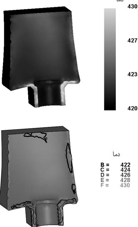
شکل ۲۵ توزیع دما در قالب -  $420^{\circ}\text{C}$  = دمای قالب،  $450^{\circ}\text{C}$  = دمای قطعه کار و  $0/5\text{ mm/s}$  = سرعت پرس
