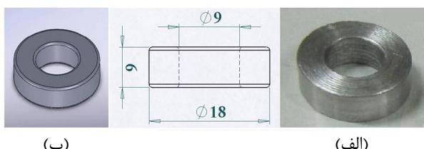
شکل ۳ الف- نمونه استفاده شده برای آزمایش حلقه ب- ابعاد نمونه استاندارد
