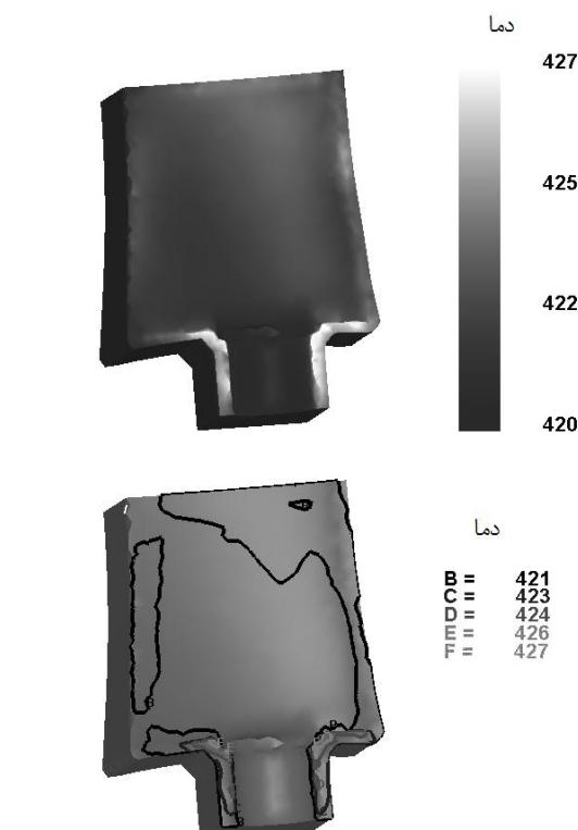
شکل ۲۶ توزیع دما در قالب -  $420^{\circ}\text{C}$  = دمای قالب،  $435^{\circ}\text{C}$  = دمای قطعه کار و  $0/5 \text{ mm/s}$  = سرعت پرس
