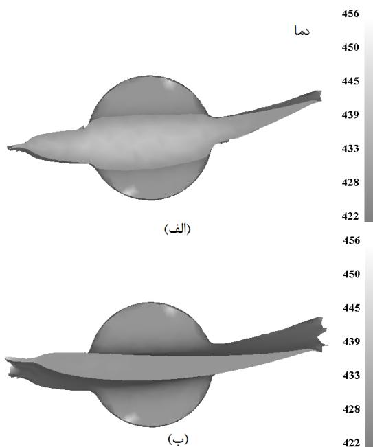
شکل ۲۷ توزیع دما در پره -  $435^{\circ}\text{C}$  = دمای قطعه کار الف- محل اتصال ریشه به بدنه ب- سطح مقطع بدنه پره
