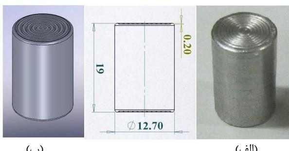
شکل ۲ الف- نمونه استفاده شده برای آزمایش فشار ب- ابعاد نمونه استاندارد
