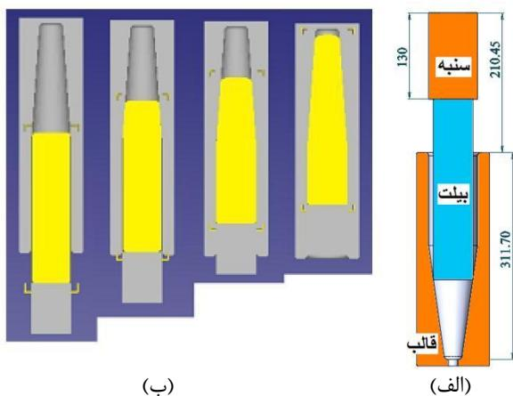
شکل ۸ الف- قالب اکستروژن ب- مراحل تغییرشکل
