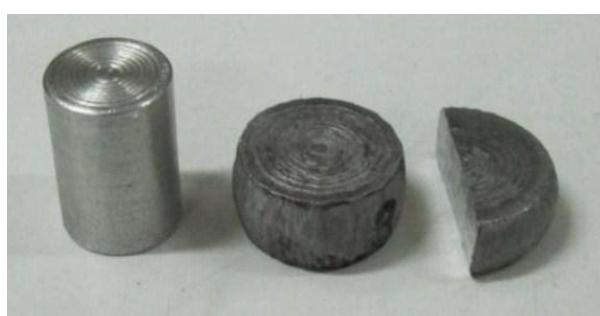
شکل ۴ نمونه‌های فشار (از راست به چپ): کاهش ارتفاع  $3.6\%$ ،  $50\%$  و قبل از تغییر شکل
