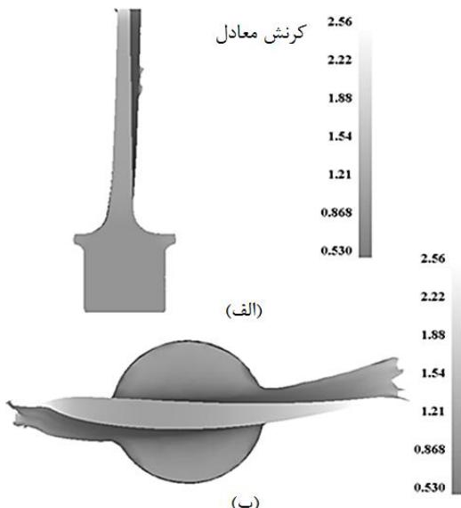
شکل ۲۸ توزیع کرنش در پره -  $450^{\circ}\text{C}$  = دمای قطعه الف- سطح مقطع طولی و مرکز ب- سطح مقطع بدنه پره
