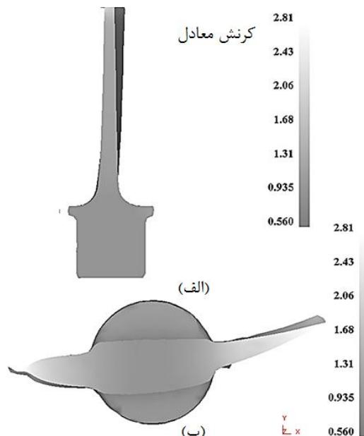
شکل ۲۹ توزیع کرنش در قطعه کار -  $435^{\circ}\text{C}$  = دمای قطعه کار
