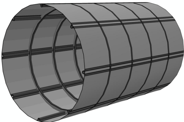
شکل 1 شمای پوسته استوانه‌ای تقویت‌شده توسط ریب و استرینگر [14]
