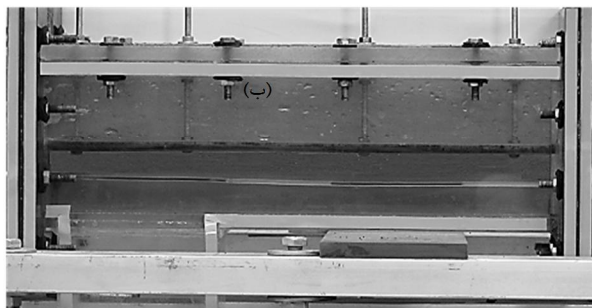
شکل ۱۲ نمونه‌هایی از تغییرات کسر تهی ( \alpha ) با دبی فازها، (الف) Q_g=64/8 ، Q_f=7 و Q_g=64/8 و Q_f=4 (ب) \alpha=0/4 ، Q_g=225/4 و Q_f=5 ، دبی‌ها بر حسب m^3/hr می‌باشند.
