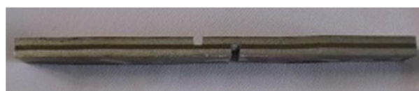
شکل 5 نمونه آماده شده جهت تست استحکام برشی مطابق با استاندارد ASTM-D-3165-95
